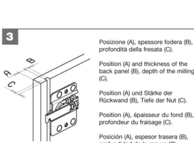
Posizione (A), spessore fodera (B), profondità della fresata (C).
